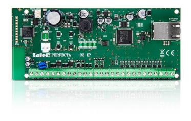
Die Zentrale ermöglicht, das System in zwei Bereiche zu teilen, wobei drei Scharfmodi zur Auswahl stehen (Tag-Scharfschalten, Nacht-Scharfschalten, Externscharfschalten). Jede Meldelinie kann einem oder den beiden überwachten Bereichen zugeordnet werden.
